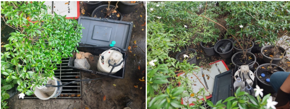
เก็บตัวอย่างน้ำทิ้งที่บ่อปรับสมดุลน้ำเสีย และพักน้ำไหลหลังจากจากระบบบำบัดน้ำเสีย ด้วย Sampling Pump
