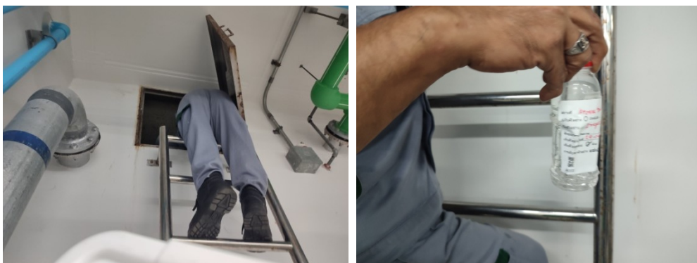
เก็บตัวอย่างน้ำใช้ที่ถังสำรองน้ำใช้
